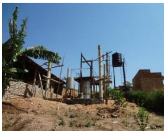
SORAK が所有するエッセンシャルオイルの蒸留機。農家からレモングラスを収集し、ここでレモングラスのオイルを生成する。
