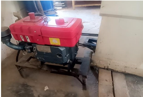
新たに購入したディーゼルエンジンでミキサーを作動
